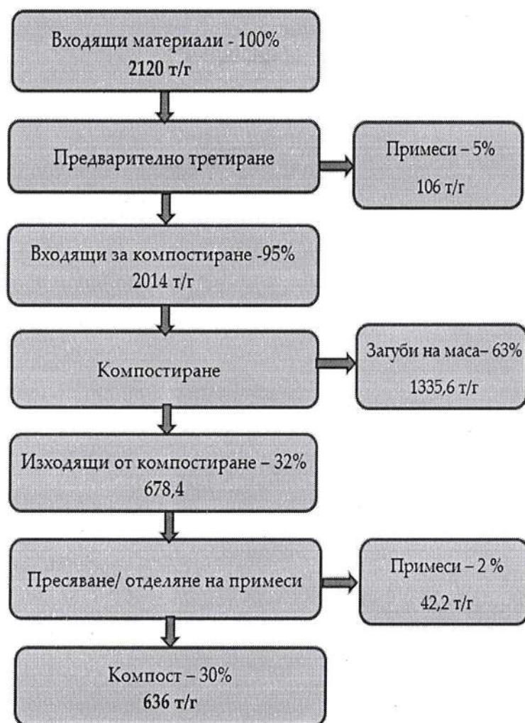
Фигура 3 Масов баланс на Клон 2 (хранителни отпадъци) на инсталацията за компостиране
