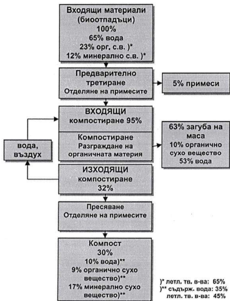
Фигура 1 Масов баланс в процеса на компостиране (източник Инструкции за определяне на национални технически изисквания към съоръженията за третиране на биоотпадъците (компостиране))
