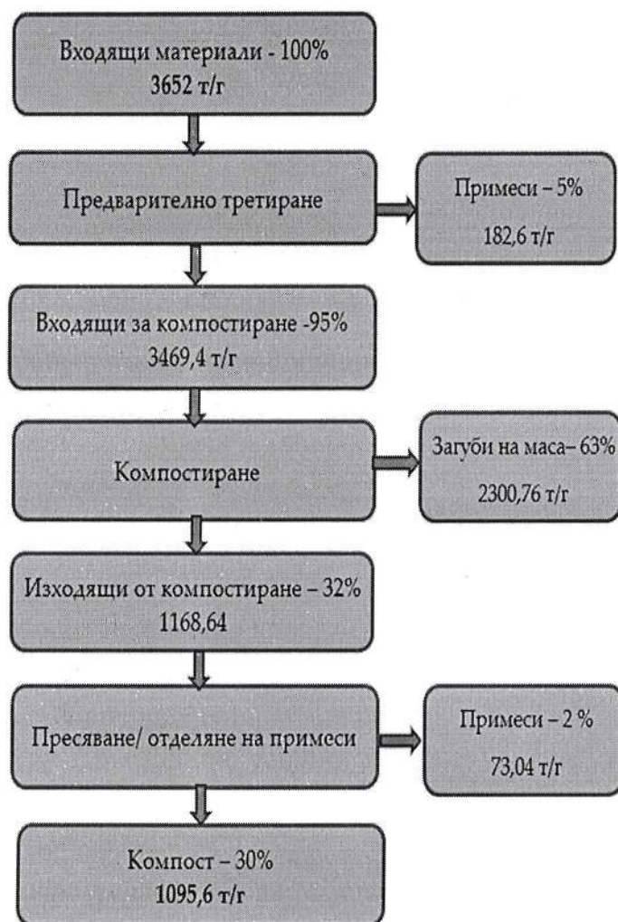
Фигура 2 Масов баланс на Клон 1 (зелени отпадъци) на инсталацията за компостиране
